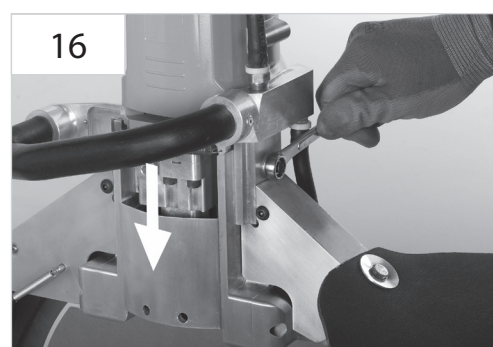
Spingere e tenere premuto l'alloggiamento contro il bordo del banco. Serrare la protezione con il paraspruzzi. Utensile: chiave inglese 1/2"
