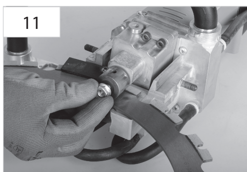
11 Avvitare la puleggia di azionamento a filo manualmente.
