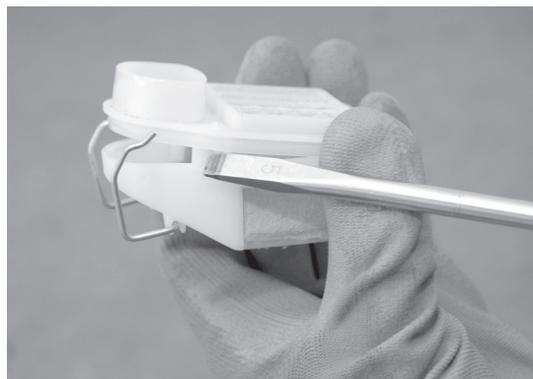
6. Come mostrato in foto, separare la parte superiore da quella inferiore del filtro dell'aria. Sbattere delicatamente o soffiare aria compressa all'interno con cautela.
