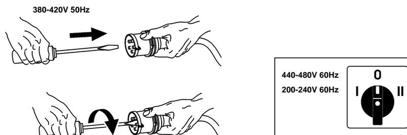
Fig. 4-2 Prise de courant avec inverseur de phases
